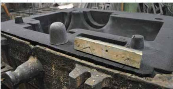
工場内の様子：砂で製作した鋳型
