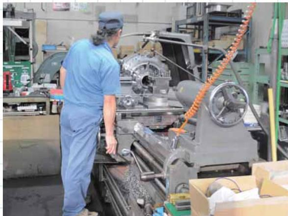
普通旋盤で航空機部品の旋削加工を行う
