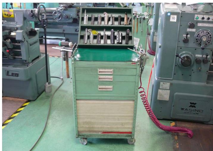
[注6] テーパ部ネジ外し用工具とは、テーパ部・偏芯部・ネジ部などが噛み込んだ場合などに部品を傷付けずに掴み、緩める為の工具を指し、下記の写真の様なものを推奨するが、この限りではない。
